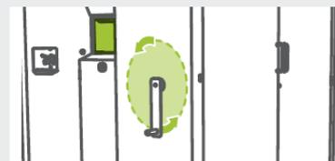
A la fermeture de la porte, un nouveau cycle s'enclenche par simple rotation. La station est équipée d'une manivelle et d'un système d'engrenage qui permet une rotation manuelle aisée sans électricité.
