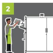
2 Incorporer les déchets dans une cuve inox d'un volume de 500 litres tels que les restes de légumes, de fruits, de pâtes, de riz, de viandes ou de poissons et autres denrées solides.
